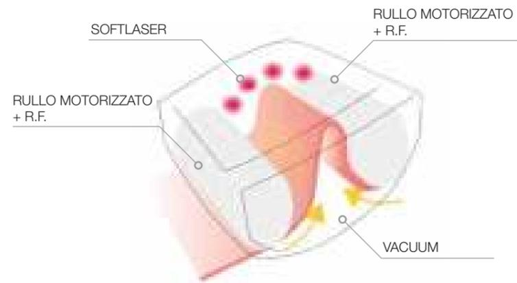
L'apparecchiatura per il massaggio endodermico crea un'aspirazione progressiva e pulsata delle pliche della pelle, con un movimento di arrotolamento e rilascio. Sfruttando l'azione di "aspirazione" della parte interessata, stimola la circolazione sanguigna e linfatica.
